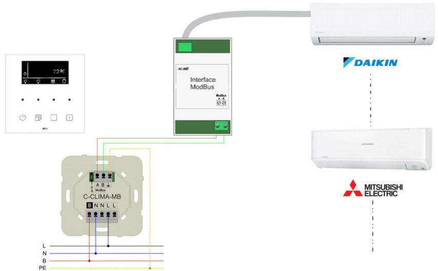
Exemplo de instalação 2: Ar condicionado + controle de aquecimento por piso radiante com teclado instalado diretamente no C-CLIMA-MB
