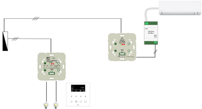
Exemplo de instalação 4: Ar condicionado + controlo de aquecimento por piso radiante com teclado instalado remotamente em um atuador C-xOUT (versão 4.x)
