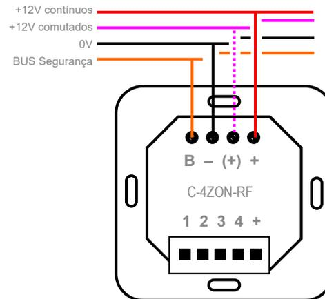
Nota: a ligação dos 12V comutados é facultativa. Esta alimentação é desligada durante o tempo de saída para permitir reiniciar os detetores com memória "latch" (do tipo quebra-de-vidros por exemplo).
