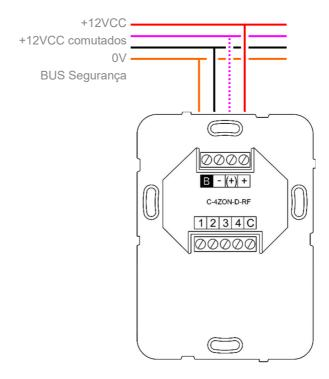
Nota: A ligação dos 12VCC comutados é facultativa. Esta alimentação é desligada durante o tempo de saída para permitir reiniciar os detetores com memória "*latch*" (do tipo quebra-de-vidros por exemplo).
