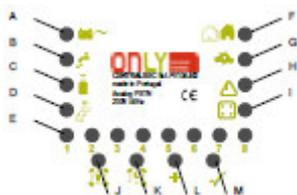
O sistema pode ser configurado para tocar as sirenes só quando houver deteções em 2 ou mais zonas. Desta forma os alarmes falsos são praticamente eliminados. Obviamente, o sistema executa a rotina de alarme imediatamente à primeira deteção, só as sirenes não tocam. Deve ter-se em atenção que esta funcionalidade só deve ser usada se duas zonas diferentes cobrem a mesma área de proteção. Esta opção só pode ser alterada no menu gestor.
