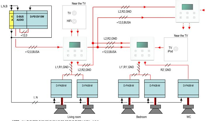
NOTE: -ALL THE RED CABLES SHOULD BE OF THE TYPE LIYCY n X 0.5 mm
